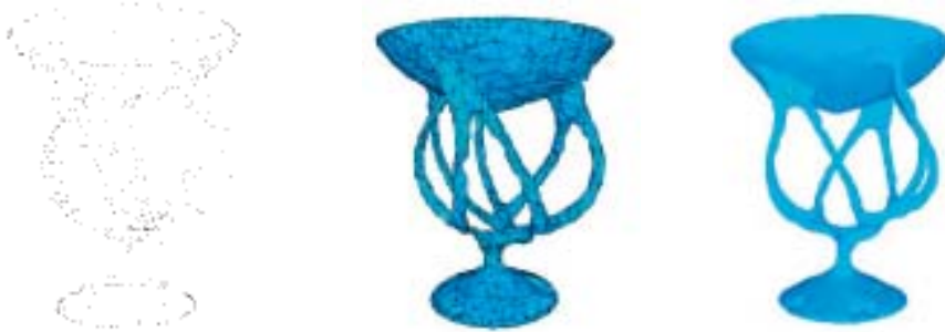
شکل ۱. بازسازی یک رویه به کمک یک نمونه از نقاط آن: این مسأله در حوزه‌های گوناگون مطرح
